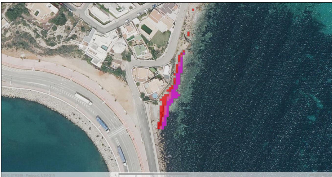
Figura 25 Escenario para 2050 de inundación permanente y extremal (RCP8.5) en la zona del dique FREU Illa Plana (calle Botafoc).
