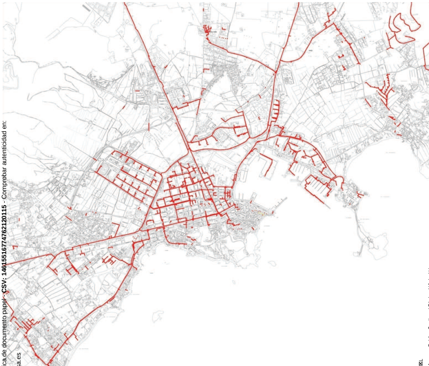
Canalització subterrània de telefonia i dades.
