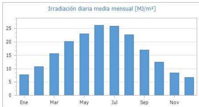
Fig. 1: Irradiación anual media mensual sobre el plano horizontal [MJ/m 2 ]- Fuente datos: Meteonorm 7.1
